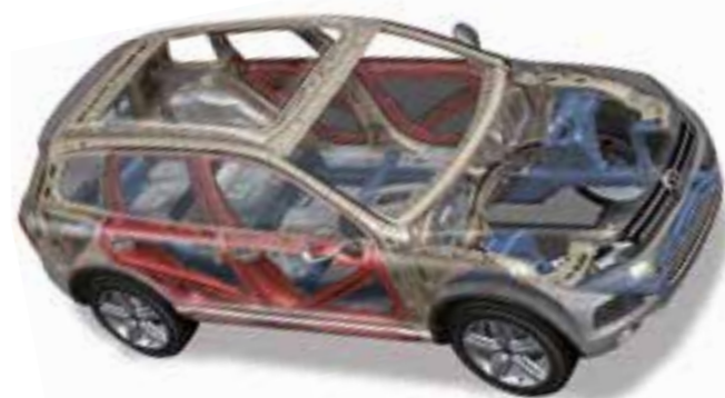
Estructura reforzada y destrucción programada en caso de impacto reduciendo daños en los ocupantes.
