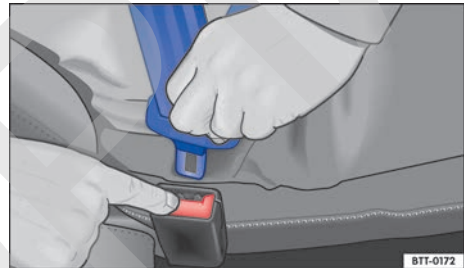
Fig. 29 Soltar la pestaña de encastre del cinturón de seguridad del cierre del cinturón.
