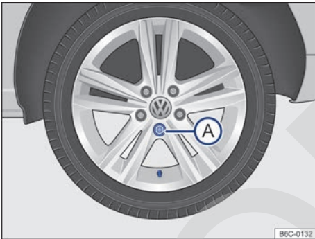
Fig. 166 Cambio de rueda: secuencia de desmontaje de los tornillos de la rueda.
