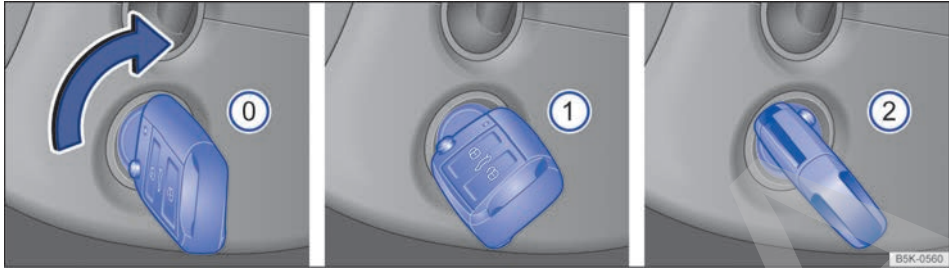
Fig. 87 Al lado del volante de la dirección, a la derecha: posiciones de la llave del vehículo en la cerradura de encendido.
