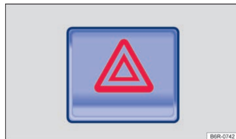
Fig. 45 En la parte superior de la consola central: interruptor de las luces de advertencia.
