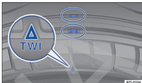
Fig. 157 Perfil del neumático: indicadores de desgaste.
