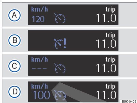
Fig. 96 En el display del instrumento combinado: indicadores del estado del GRA (representación esquemática).
