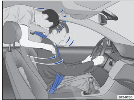
Fig. 26 El pasajero sin cinturón de seguridad en el asiento trasero es lanzado hacia adelante sobre el conductor con cinturón de seguridad.
