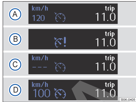
Fig. 98 En el display del instrumento combinado: indicadores del estado del GRA (representación esquemática).
