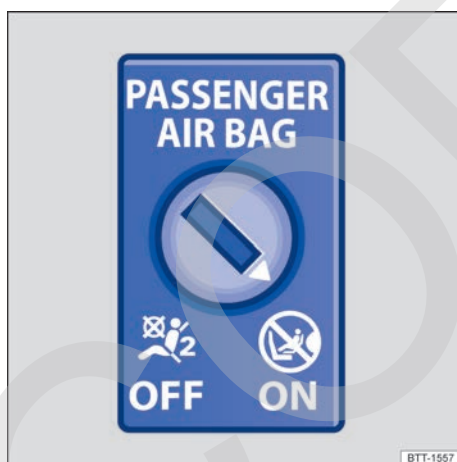
Fig. 36 En el panel de instrumentos en el lado del acompañante delantero: interruptor accionado por la llave para desconectar y conectar el airbag frontal del acompañante delantero.
