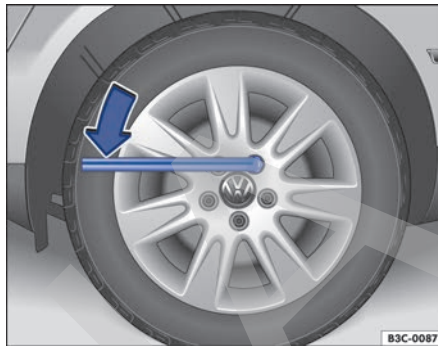
Fig. 162 Cambio de rueda: aflojar los tornillos de la rueda.
