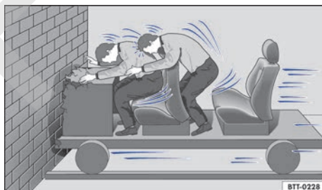
Fig. 24 Un vehículo con los ocupantes del vehículo sin cinturones de seguridad choca contra el muro.
