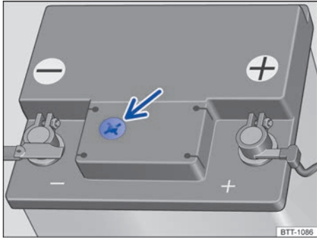
Fig. 152 En el compartimento del motor: ejemplo de posición del visor en el lado superior de la batería del vehículo.
