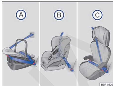
Fig. 39 Las ilustraciones A , B y C muestran la fijación del sistema de retención infantil sólo con el cinturón de seguridad del vehículo.
