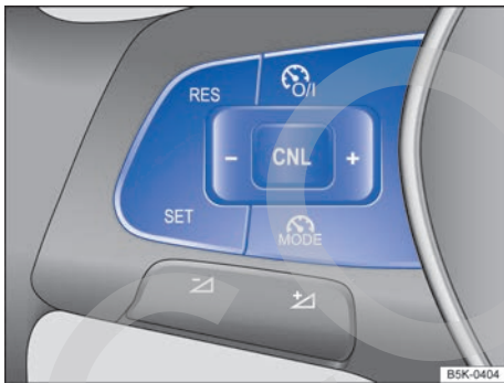
Fig. 97 Lado izquierdo del volante multifunción: teclas para comandar el GRA.
