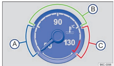
Fig. 15 Indicador de temperatura del líquido de refrigeración del motor en el panel de instrumentos (variante 2): (A) zona fría; (B) zona normal; (C) zona de alerta.
